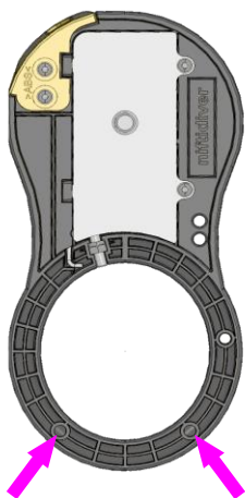
Vue avant forage : Emplacements des deux renforts circulaires.
