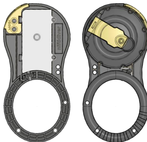
Aanzicht na het boren van de twee gaten.
