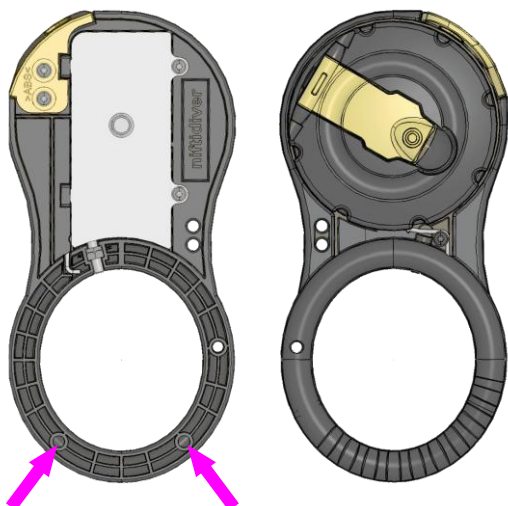
Aanzicht voor het boren : Posities van twee ronde versterkingen
